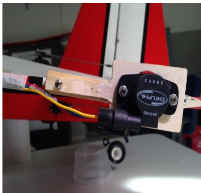
Figura 4. Sensor completo instalado no profundor do Telemaster.
