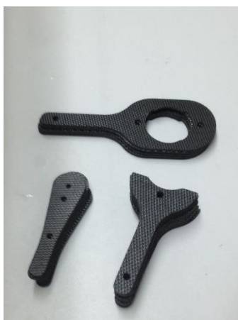
Figura 7. Peças definitivas para o sistema de medição de deflexão das superfícies de controle da aeronave em fibra de Carbono.
