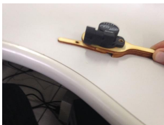
Figura 6. Nova configuração de montagem com o sensor SS10693.
